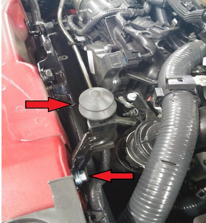
2. Jetzt gilt es diese Schraube zu lösen und diese besagte Ausrichtungsnase gerade zu biegen. Beim Biegen bitte vorsichtig sein, Grobmotoriker könnten das Teil gleich abbrechen. Das Geradebiegen dieser Nase ist für die Wiederanbringung des Sensors zwingend notwendig. Siehe dazu Bild 2.
